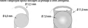
Slika 1: Tehnički crteži različitih tipova modela IOL s monofokalnom optikom kao primjerom (lijevo: modeli sa C-epitelom sa završetkom -aA/-aAY, desno: izrezani haptski modeli sa završetkom -aX/-aAX)
